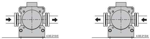
Variante 1: Saugleitung links, Druckleitung rechts
